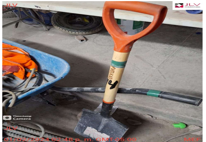
Supervisión verifica la inspección de herramientas con la cinta de inspección del mes
