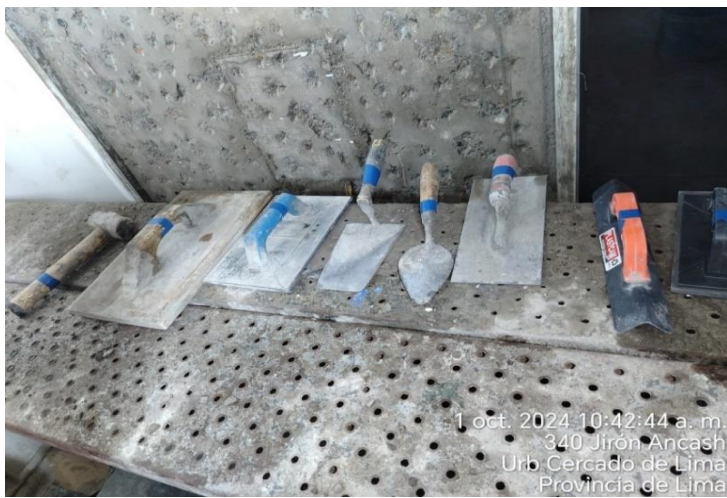
Supervisión verifica el inicio de la inspección de herramientas y colocación de cinta del mes
